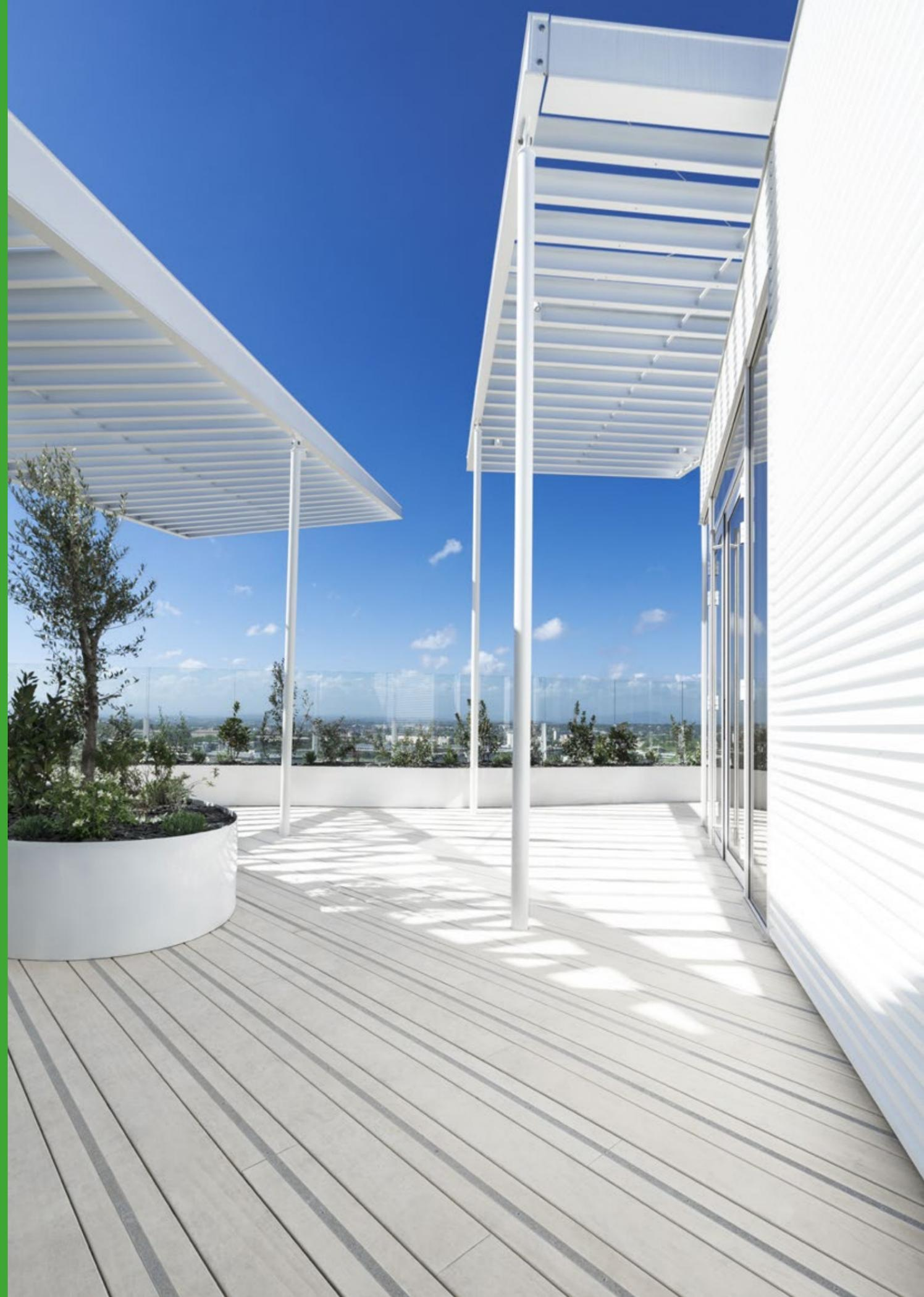
Les essais réalisés par le FCBA ont démontré la parfaite association entre les lames de platelage en Accoya® et les fixations invisibles HardWood Clip®. Elle satisfait pleinement aux exigences de la norme NF DTU 51.4. <sup>4</sup>
